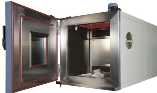
Externer Prüfraum für Vibration in Verbindung mit Explosionsöffnung. Die Versorgung erfolgt über eine Medientemperaturerung mit Wärmeträger.
