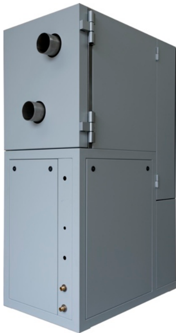
Externes Temperieraggregat zur Versorgung eines Prüfraumes mit klimatisierter Luft. Die Ankopplung geschieht über isolierte Luftschräume. Auf Rollen oder fest installiert.
